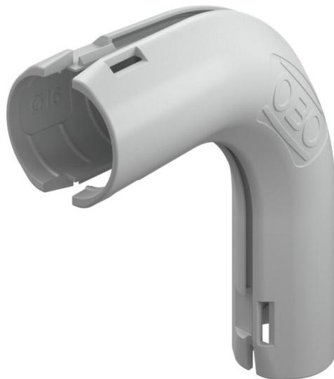
Formteil für Elektroinstallationsrohre aus Kunststoff zum Erstellen von 90°-Bögen. Geeignet für Rohr Quick-Pipe® oder Wellrohre. Werkzeugloses Verschließen und Öffnen. Einsetzbar im Temperaturbereich von - 25° bis + 60° C.
