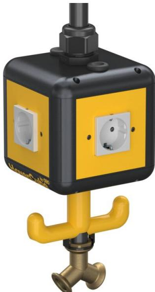
Gehäuse bestückt und vorverdrahtet, mit 1 m Rohr 1/2" und Anschluss für Druckluftschlauch 13 x 3,5 mm und 2-Wege-Verteiler 1/2", mit Aufhängeöse, Griffhaken und 4 Abdeckplatten. Bestückt wie folgt: 4 x 1fach Schutzkontakt-Steckdosen 16 A/250 V mit erhöhtem Berührungsschutz, auf zwei Wechselstromkreise vorverdrahtet, Anschluss über 2 x Klemmen 3-polig, mit Trennwand zur Stromkreistrennung.
