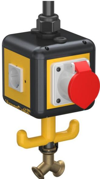
Gehäuse bestückt und vorverdrahtet, mit 1 m Rohr 1/2" und Anschluss für Druckluftschlauch 13 x 3,5 mm und 2-Wege-Verteiler 1/2", mit Aufhängeöse, Griffhaken und 4 Abdeckplatten. Bestückt wie folgt: 3 x 1fach-Schutzkontakt-Steckdosen 16 A/250 V mit erhöhtem Berührungsschutz, auf einen Wechselstromkreis vorverdrahtet, Anschluss über 1 x Klemme 3-polig, 1 x CEE-Steckdose 16 A/415 V, mit Trennwand zur Stromkreistrennung.
