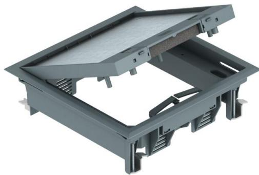
Geräteeinsatz mit Rastschieber für bis zu 6 Modul 45-Einzelgeräte in 2 Universalträger UT3, Einsatz in Kanalsystemen und Systemböden im Innenbereich. Bodenbelagaussparung im Klappdeckel voreingestellt auf 5 mm, bei Bedarf auch einstellbar auf 3, 8 oder 10 mm. Bis zu 4 Installationsgeräte mit 50er-Zentralplatte einsetzbar.
