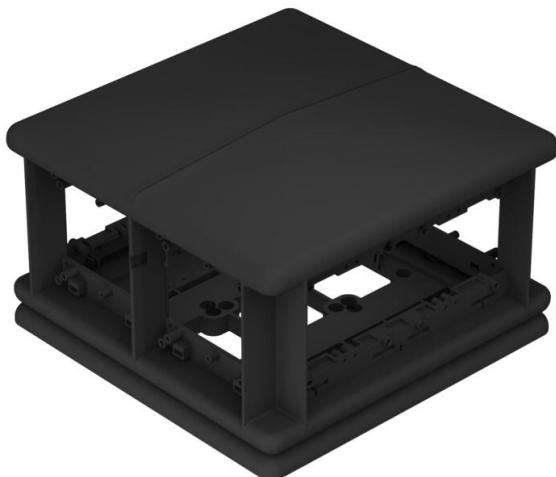
Fußbodenübergreifende Einbaueinheit für den Einbau von 8 einzelnen Installationsgeräten mit Tragering oder -bügel auf 4 Seiten. Die Trennung der Stromarten (4 + 4) erfolgt mittels einer Trennwand. Bei Verwendung von Mehrfach-Installationsgeräten kann die Anschlusskapazität erhöht werden. Schraubbefestigungs spur für Installationsgeräte: 60 mm senkrecht.
