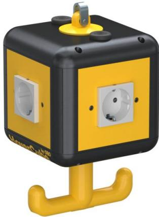
Gehäuse bestückt und vorverdrahtet mit Aufhängeöse, Griffhaken und 4 Abdeckplatten. Bestückt wie folgt: 4 x 1fach-Schutzkontakt-Steckdosen 16 A/250 V mit erhöhtem Berührungsschutz, auf zwei Wechselstromkreise vorverdrahtet, Anschluss über 2 x Klemmen 3-polig, mit Trennwand zur Stromkreistrennung.
