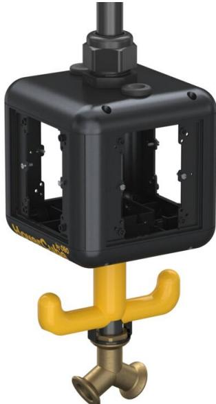
Leergehäuse mit 1 m Rohr 1/2" und Anschluss für Druckluftschlauch 13 x 3,5 mm und 2-Wege-Verteiler 1/2". Mit Aufhängeöse und Griffhaken, zum Einbau von 4 elektrischen Betriebsmitteln, mit beigelegter Trennwand. Ohne Abdeckplatten.
