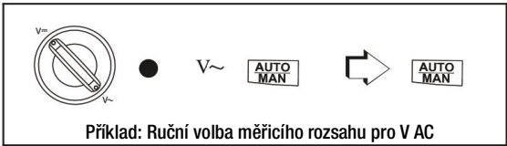
Příklad: Ruční volba měřícího rozsahu pro V AC
