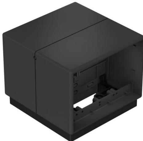
Zum kombinierten Einbau von 4 einzelnen Installationsgeräten mit Tragebügel (4 Installationsgeräte einer Stromart oder jeweils 2 Installationsgeräte zweier Stromarten). Die verschiedenen Stromarten werden durch eine Trennwand gegeneinander isoliert. Schraubbefestigungsspur für Installationsgeräte: 60 mm senkrecht.
