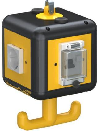
Der Hovercube VH-4 mit dezentraler Absicherung löst im Fall eines Über-/Fehlerstroms (16 A/30 mA) den FI/LS-Schalter direkt aus. Das Wiedereinschalten kann direkt an der Versorgungseinheit erfolgen.
