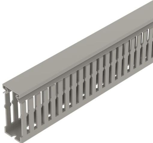
Verdrahtungskanal inkl. Oberteil und Bodenlochung zur waagerechten und senkrechten Verlegung elektrischer Kabel und Leitungen im Schaltschrank. Das Ausbrechen der Stege erfolgt werkzeuglos. Sonderlängen auf Anfrage. Geprüft nach DIN EN 50085-2-3. Unter- und Oberteil im Set.
