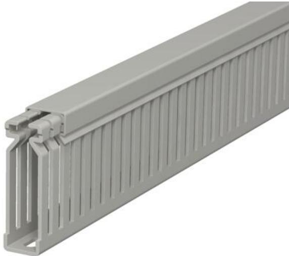
Verdrahtungskanal inkl. Oberteil und Bodenlochung zur waagerechten und senkrechten Verlegung elektrischer Kabel und Leitungen im Schaltschrank. Ausführung als metrischer Kanal. Das Nennmaß der Systemgröße entspricht dem Innenmaß der Kanäle. Das Ausbrechen der Stege erfolgt werkzeuglos. Bodenbündiges Ausführen ist durch Sollbruchstellen möglich. Geprüft nach DIN EN 50085-2-3. Sonderlängen auf Anfrage.
